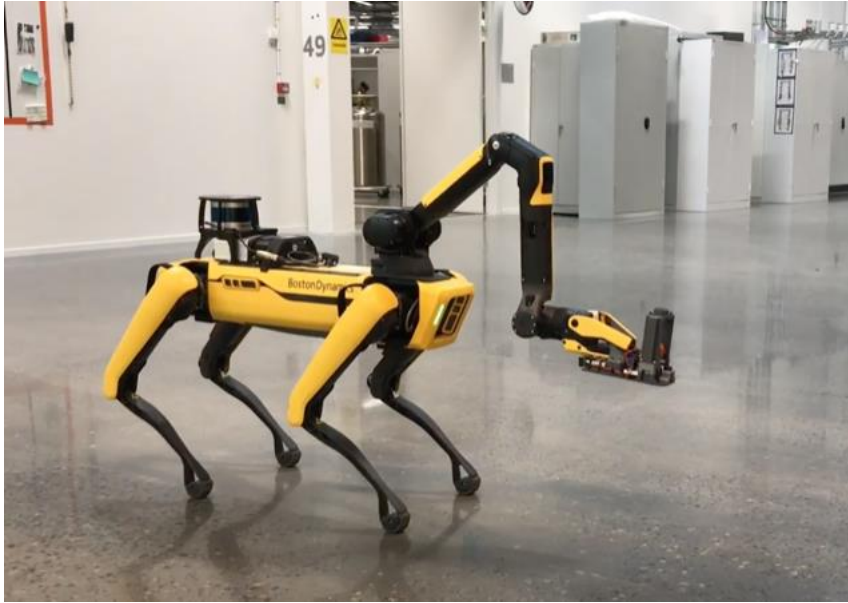
Bild 6. Utsättning med robothundens arm. Ett tillverkat handhållet verktyg innehållande markerings- och mätfunktionalitet nyttjas för utsättning.
